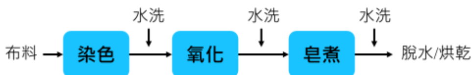
圖 6 合成藍靛染料染色程序
