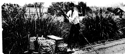
⇒ 搬運作用的台車：在搬運輕的物品時，如圖所示，以竹竿撐地推行台車。 地點：羅東附近。
